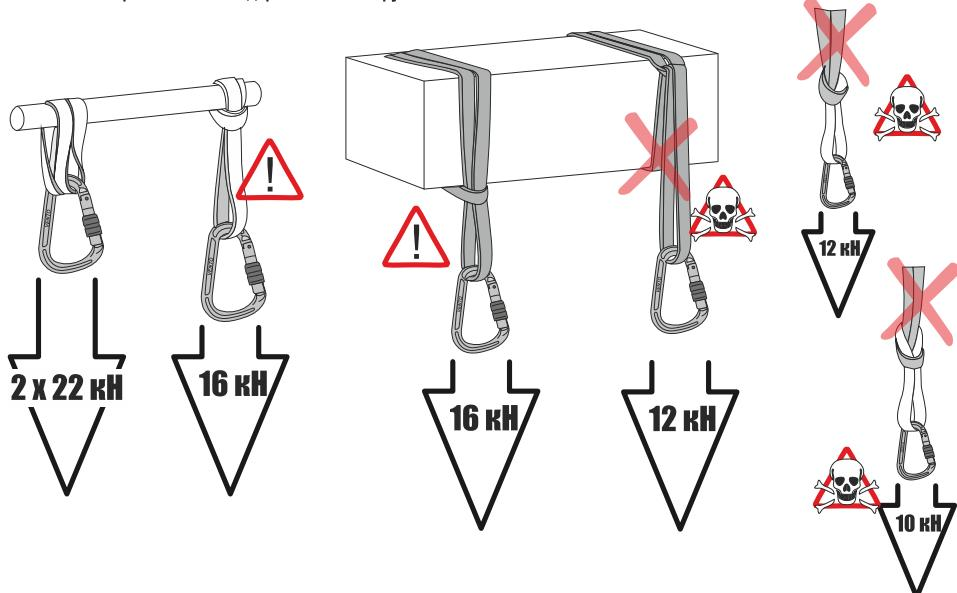
Рис. 3. Распределение нагрузок на анкерные точки в зависимости от углов
